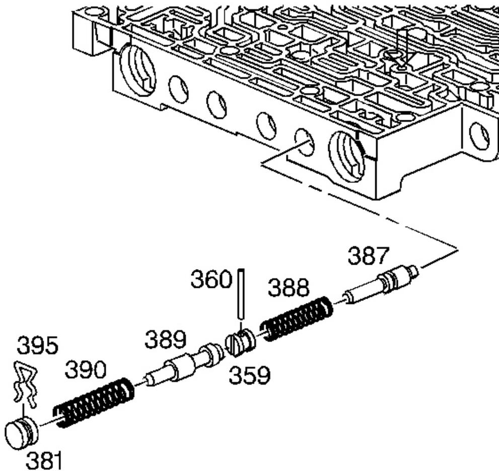
**Fig. 256: View Of Reverse Abuse Valve & 3-2 Downshift Valve**
