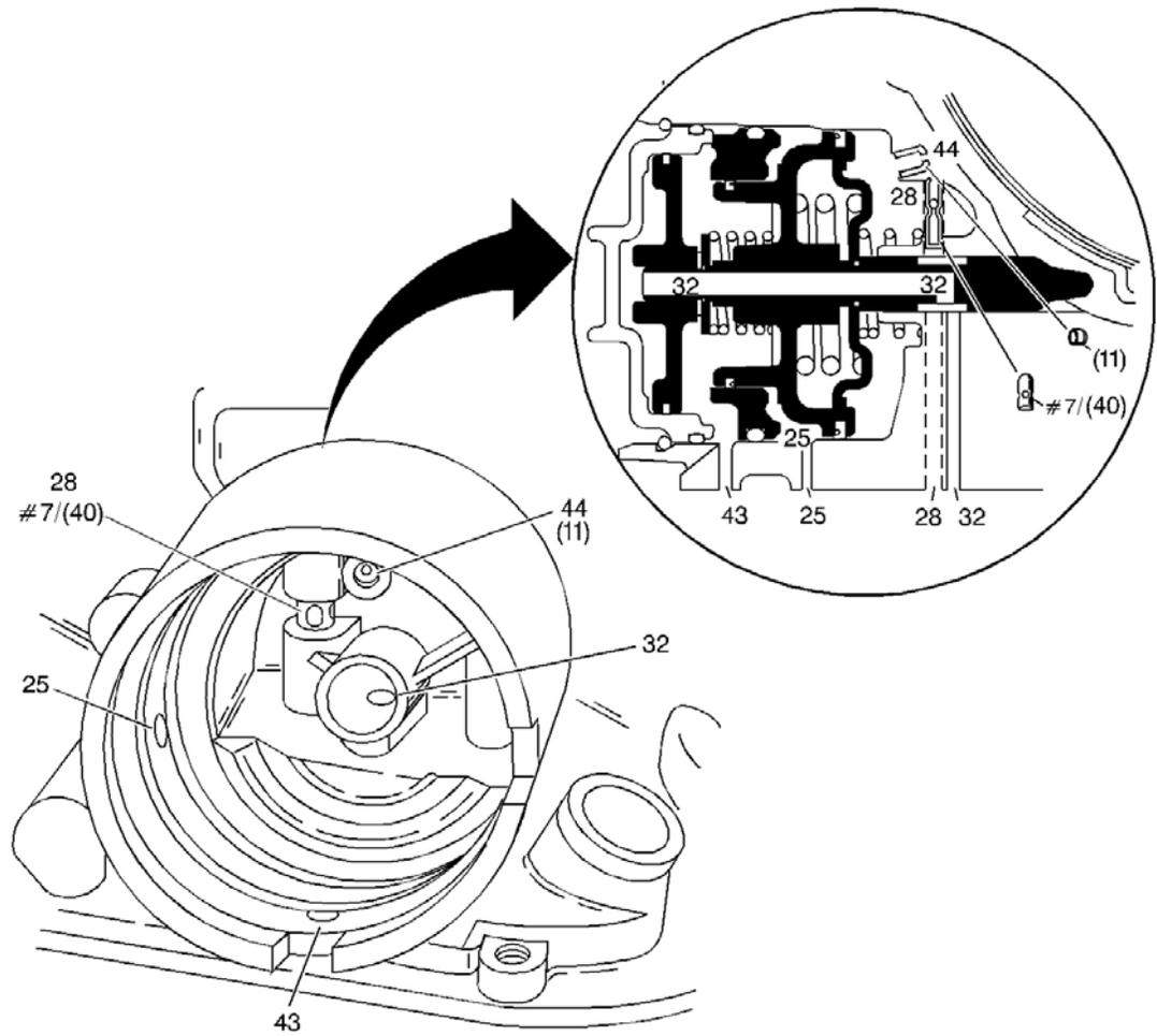
**Fig. 344: 2-4 Servo Fluid Passages**
