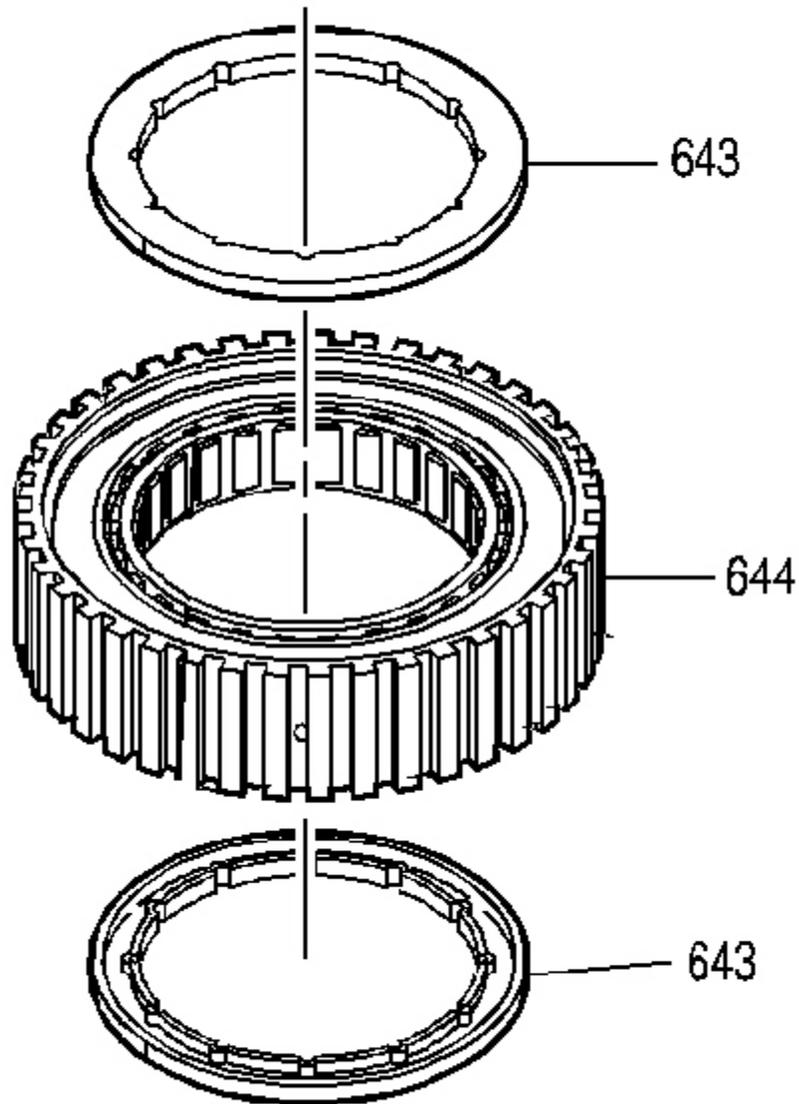
**Fig. 172: View Of Sprag Assembly Retainer Rings**
