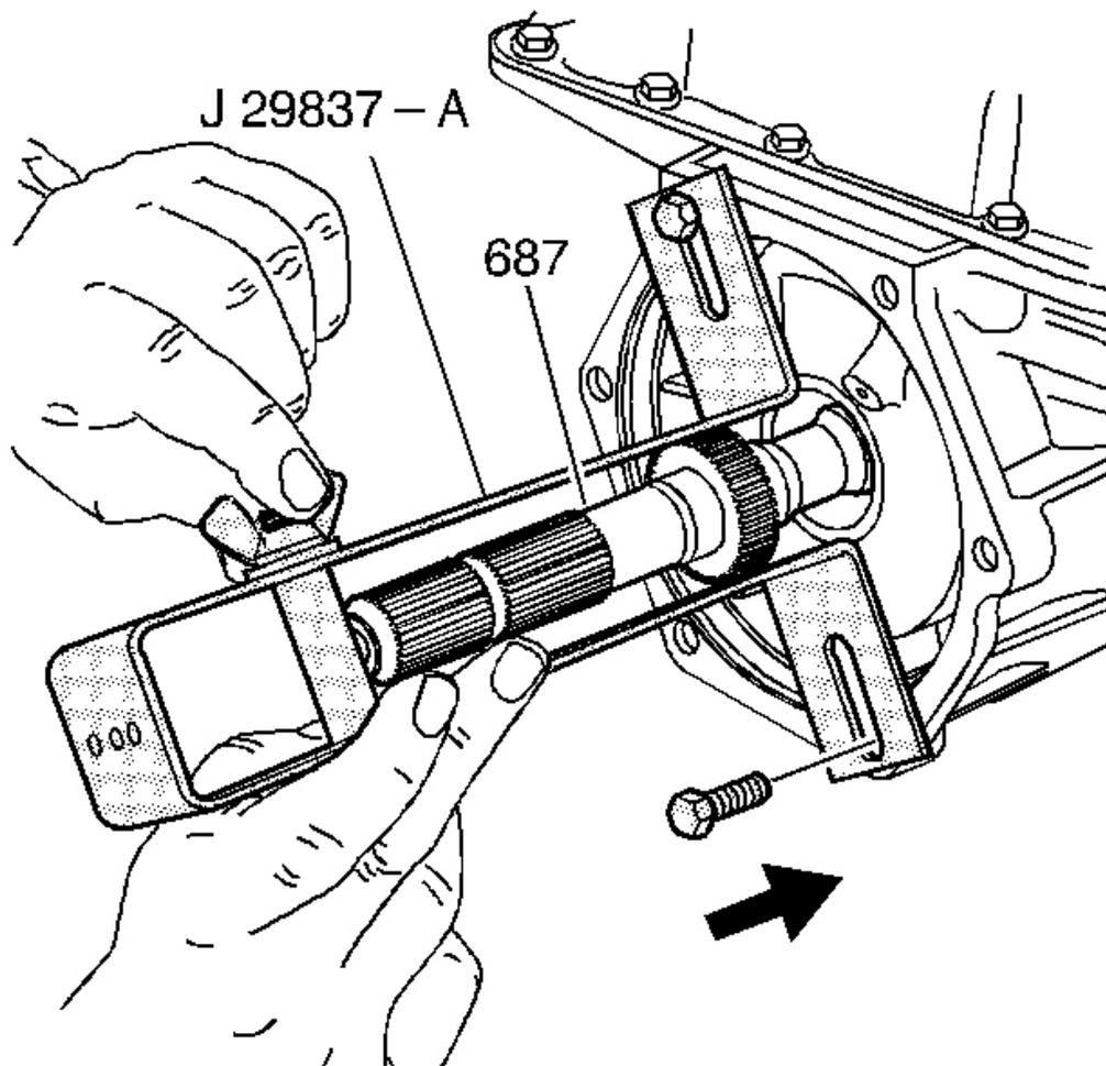
**Fig. 35: Installing J 29837-A**
