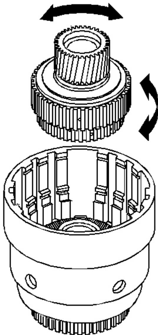
**Fig. 175: Checking Sun Gear Rotation**
