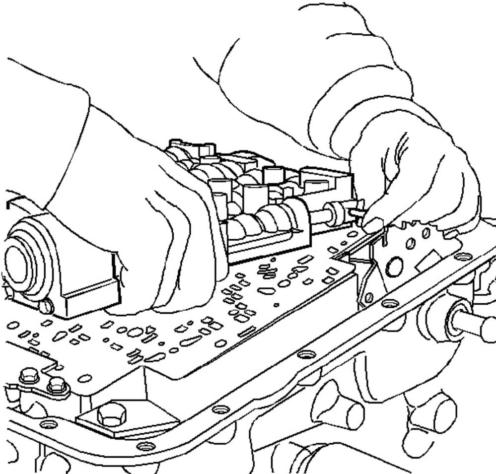
**Fig. 285: Installing Valve Body**
