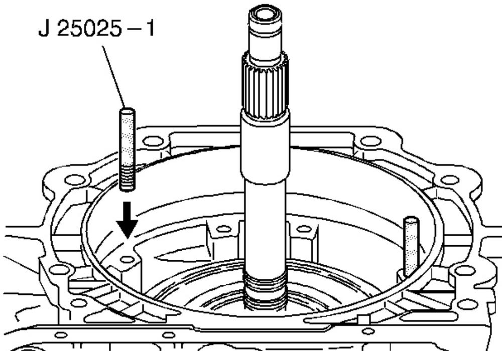
**Fig. 237: Installing J 25025-1**
