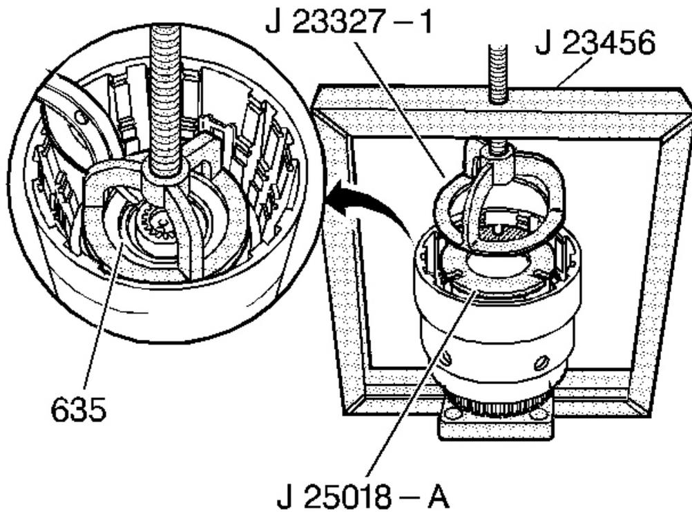
**Fig. 149: Installing J 23327-1 & J 25018-A**
