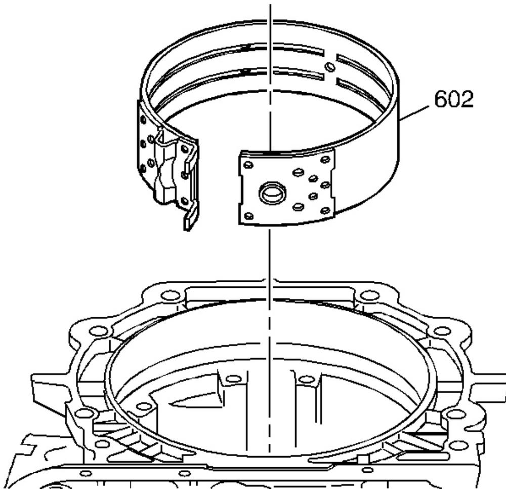
**Fig. 204: View Of 2-4 Band Assembly**
