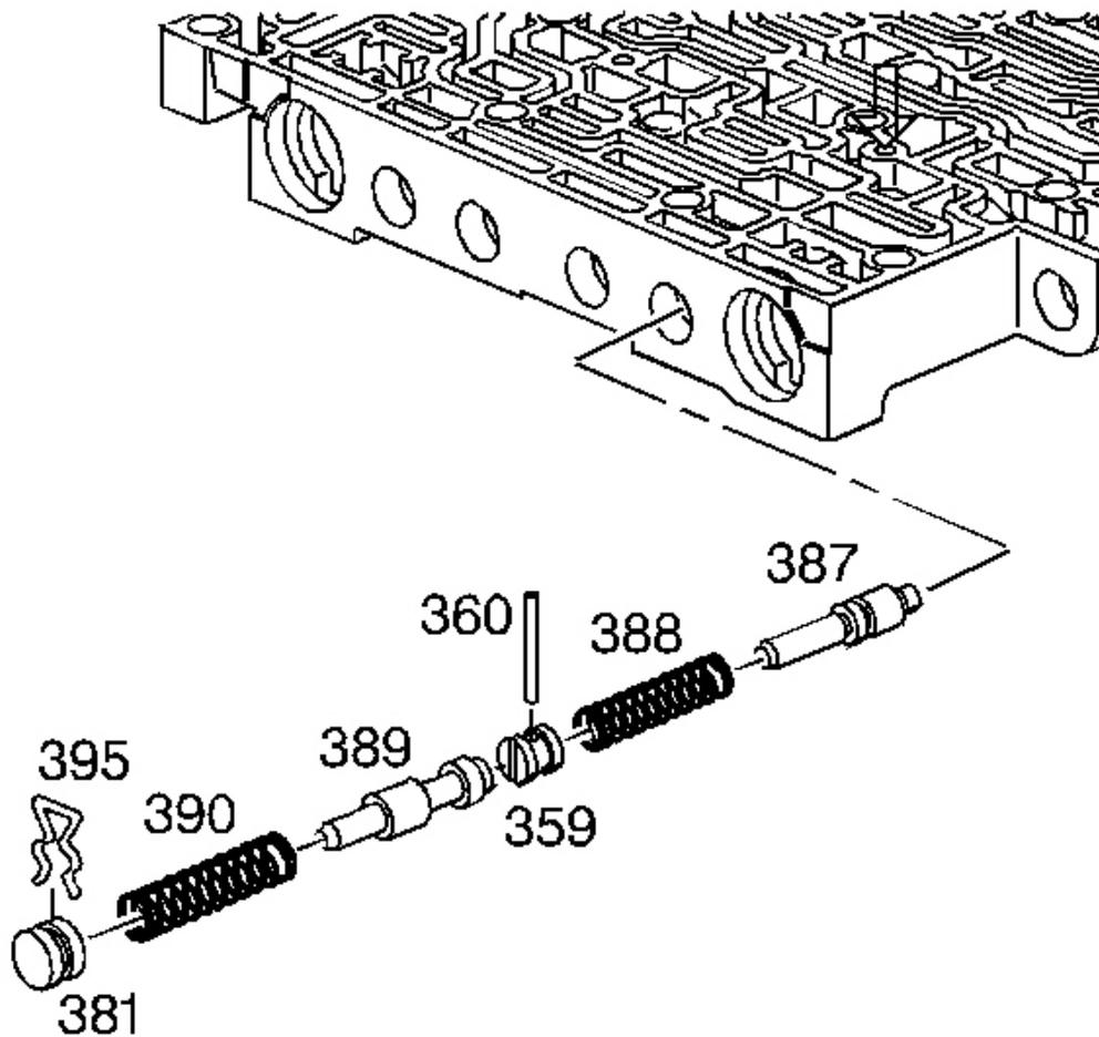
**Fig. 264: View Of Reverse Abuse Valve & 3-2 Downshift Valve**
