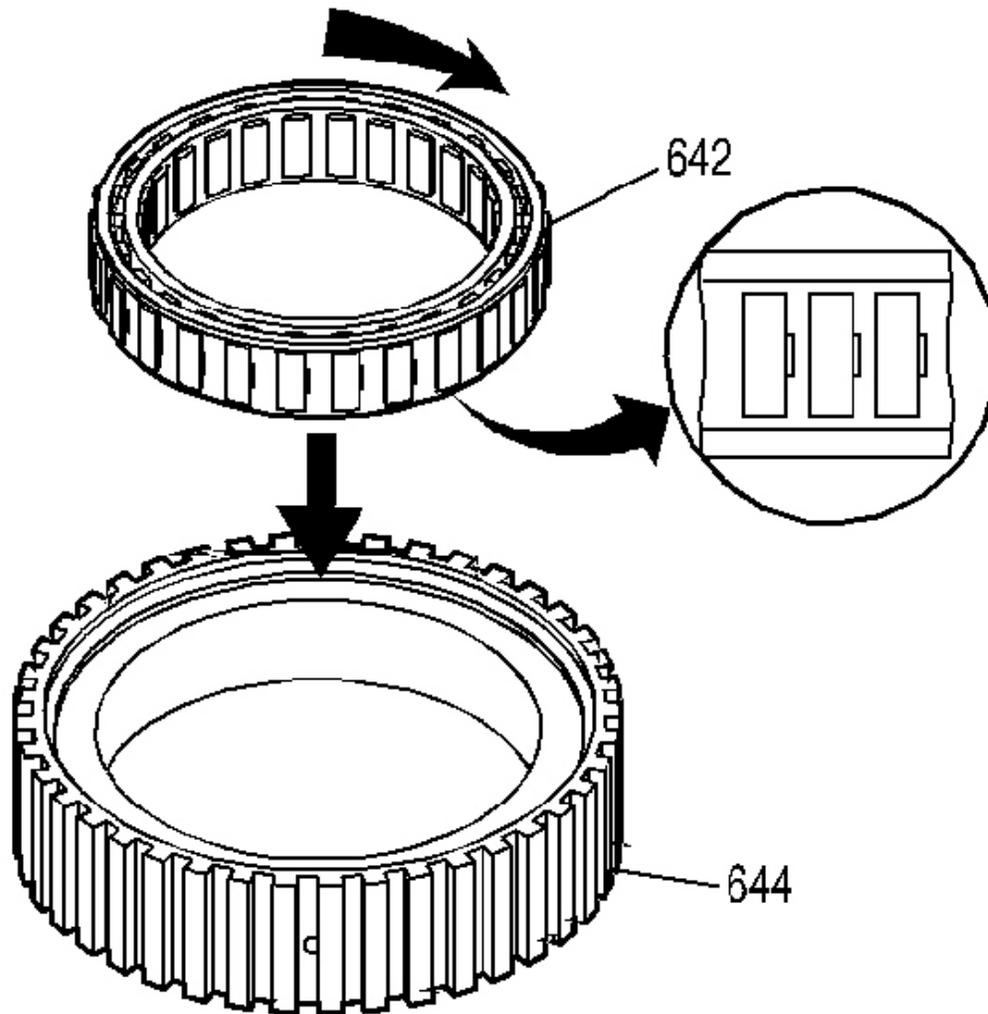
**Fig. 171: Forward Sprag Assembly**
