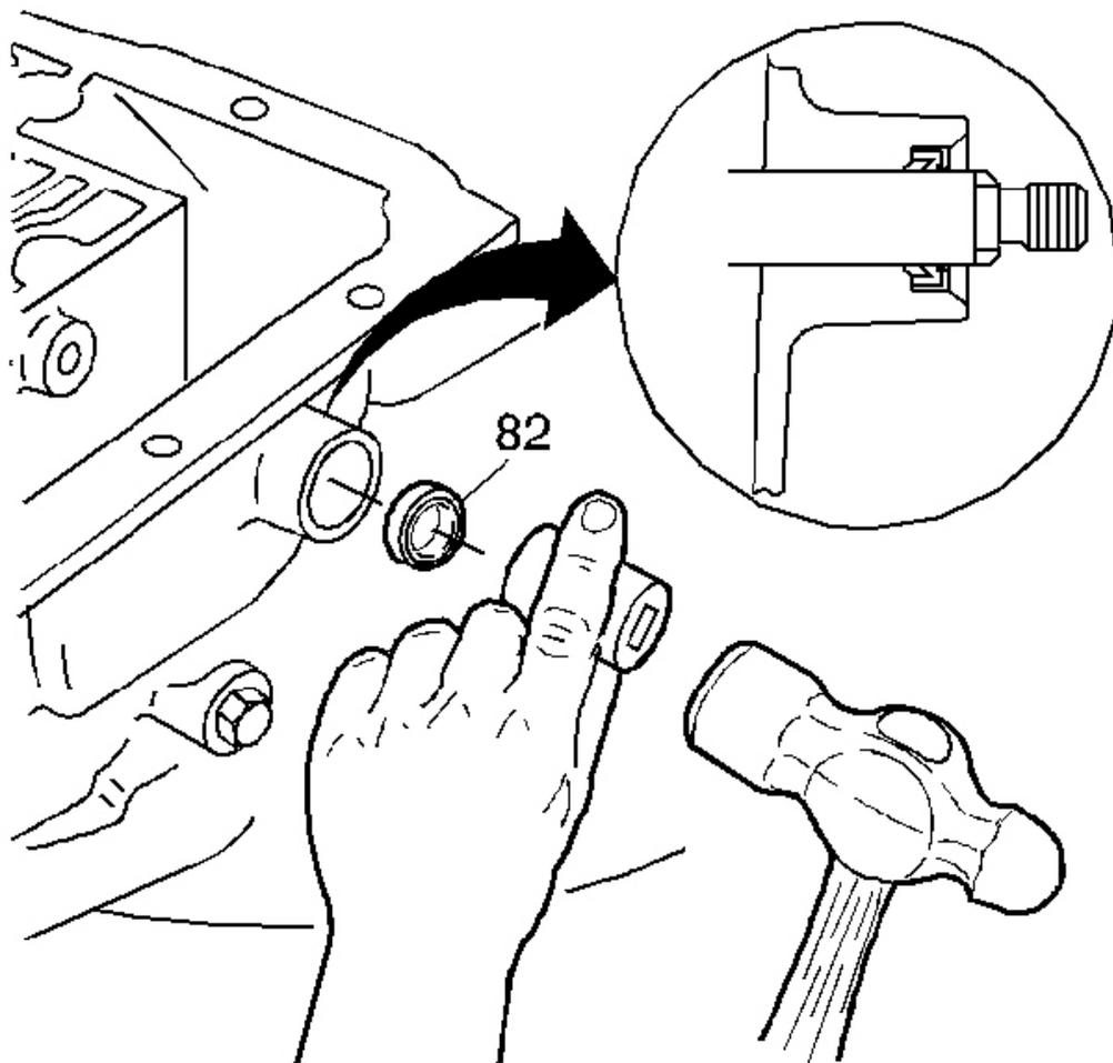
**Fig. 99: Installing Manual Shaft Seal**
