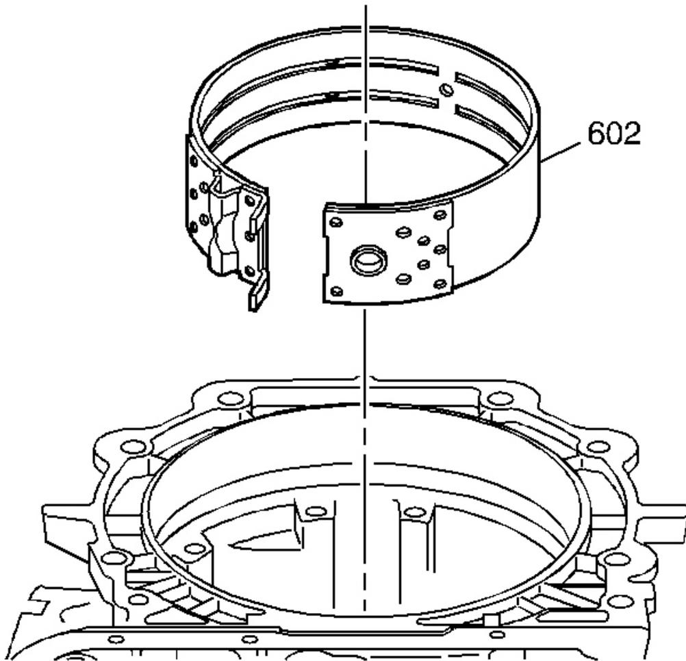
**Fig. 65: View Of 2-4 Band Assembly**
